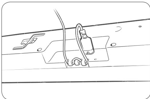
Provucite kabl kroz deo za rasterećivanje naprezanja u sredini. Uz korišćenje ovog dela, utikač kabla za napajanje iz motora neće se izvlačiti i neće doći do mogućeg kvara.
