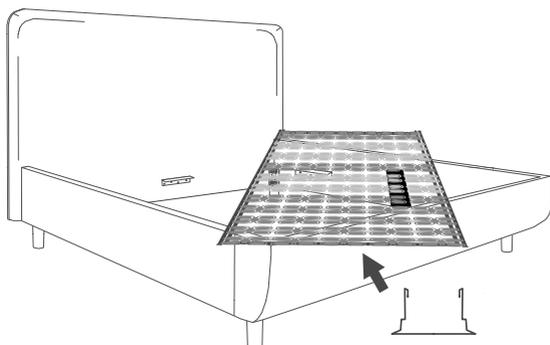
Šipka za dušek treba da se pričvrsti na potporni okvir, ispod letvica, na podnožje. Izvlačenjem uklonite prvu letvicu s diskovima. Najpre izvucite letvicu na jednom kraju, a zatim i na drugom.
