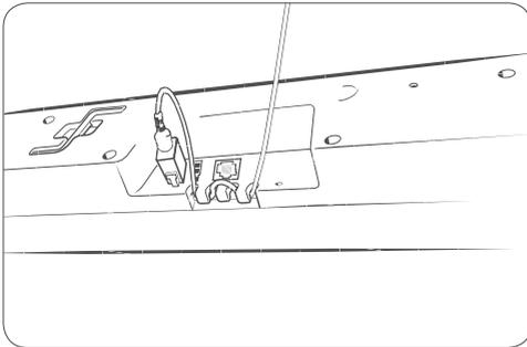
Provucite kabl kroz deo za rasterećivanje napreznja u sredini. Uz korišćenje ovog dela, utikač kabla za napajanje iz motora neće se izvlačiti i neće doći do mogućeg kvara.
