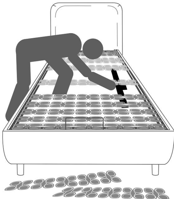
3. Uzmite imbus ključ iz dela gde je motor. Izgurajte ga pomoću olovke ili nečega što imate u kući.
