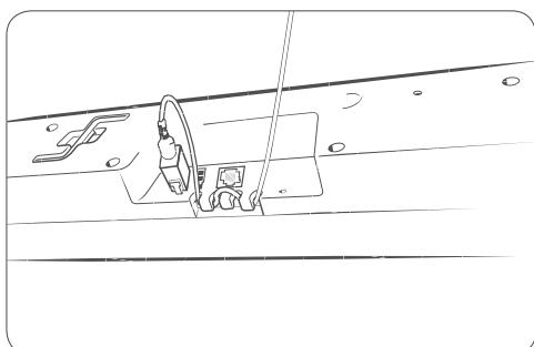
Provredite kabel oko srednje uvodnice. Uvodnica sprječava izvlačenje kabela za napajanje iz motora i mogući kvar.
