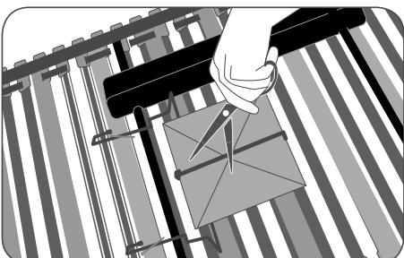
Uklonite kopču za pričvršćivanje kabela.
