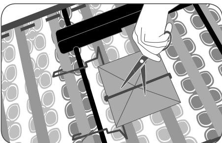
Uklonite kopču za pričvršćivanje kabela.
