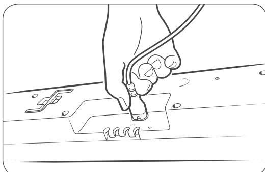
Spojite kabel za napajanje na napajanje motora.
