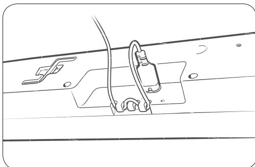
Provedite kabel oko srednje uvodnice. Uvodnica sprječava izvlačenje kabela za napajanje iz motora i mogući kvar.
