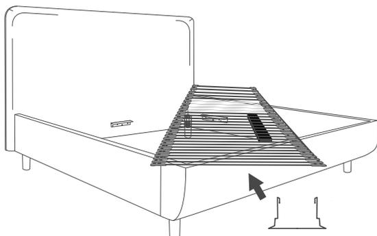
La barra de sujeción para el colchón debe acoplarse al bastidor y fijarse en la segunda lámina empezando por el final de la zona de los pies.
