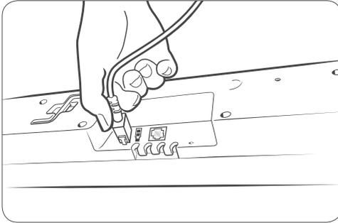
Conecte el extremo con la clavija adecuada en la toma del motor e inserte el otro extremo en el adaptador. Inserte la otra clavija en el adaptador.
