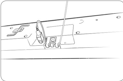
Pase el cable por la sujeción central. Al utilizar la sujeción, se evita que la clavija del cable de alimentación se salga del motor y cause un posible fallo.
