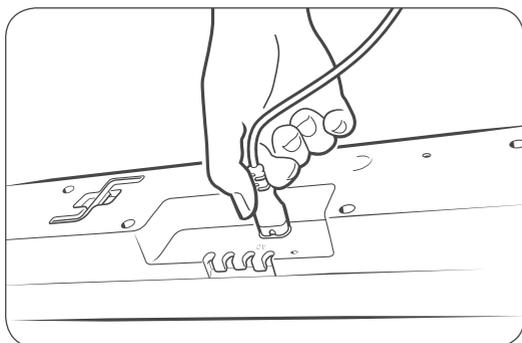
Conecte el extremo del cable de alimentación a la toma del motor.
