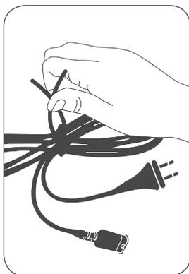
Retire la brida de sujeción de los cables.
