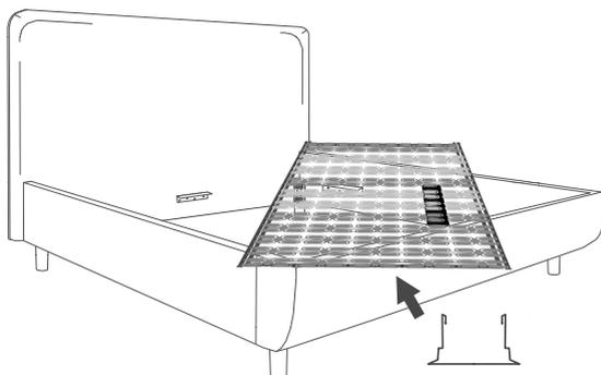
La barra de sujeción para el colchón debe acoplarse al bastidor, debajo de las láminas, en la zona de los pies.
